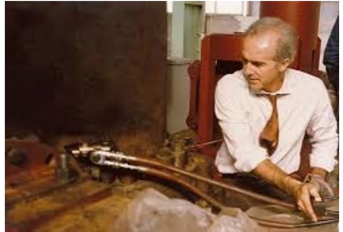
Domenico Zicchino mentre effettua una dimostrazione di utilizzo di una chiave idraulica dinamometrica
