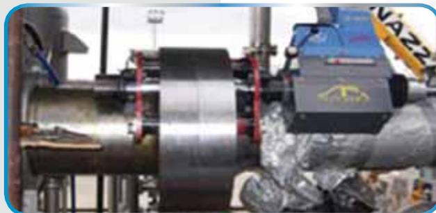
*Alesatura di fori per giunti calibrati*
