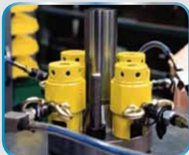
*Serraggio e disserraggio mediante tensionamento idraulico di tiranteria*
