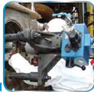
*Tornitura e alesatura di fori e lavorazione di superfici*
