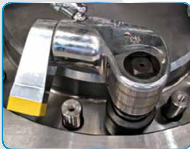
*Serraggio a coppia controllata e disserraggio di bullonature*
