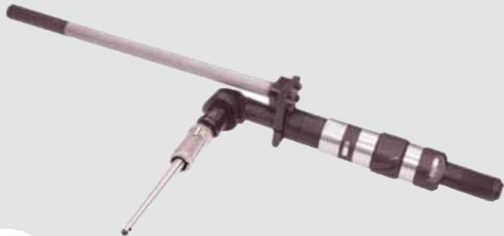
Design unico della testa realizzato includendo completamente i cuscinetti per una maggiore durata dell'attrezzatura. Entrambi i modelli sono forniti con un acceleratore della velocità di rullatura standard. La leva di comando della velocità è invece opzionale. Coppia facilmente regolabile. L'angolo della testa può essere orientato in numerose posizioni. Lo scarico dell'aria è orientabile a 360°.
